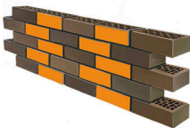
2 ЛОЖКОВАЯ КЛАДКА СМЕЩЕНИЕ НА 1/2 КИРПИЧА
