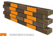
3 ЛОЖКОВАЯ КЛАДКА СМЕЩЕНИЕ НА 1/4 КИРПИЧА
