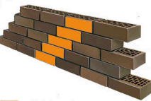
3 ЛОЖКОВАЯ КЛАДКА КОСОЕ СМЕЩЕНИЕ НА 1/4 КИРПИЧА
